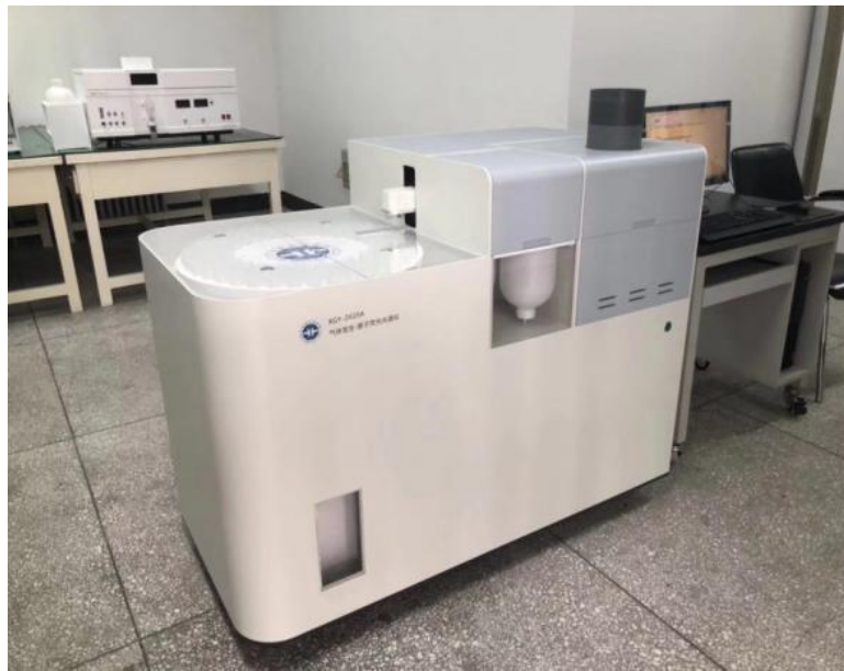
自主研发的 XGY-2020A 型全自动双通道气体发生原子荧光光谱仪
