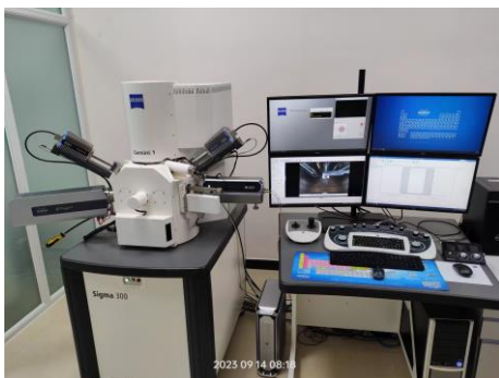
德国 Zeiss Sigma 300 场发射扫描电镜+Bruker 双能谱+EBSD+CL
