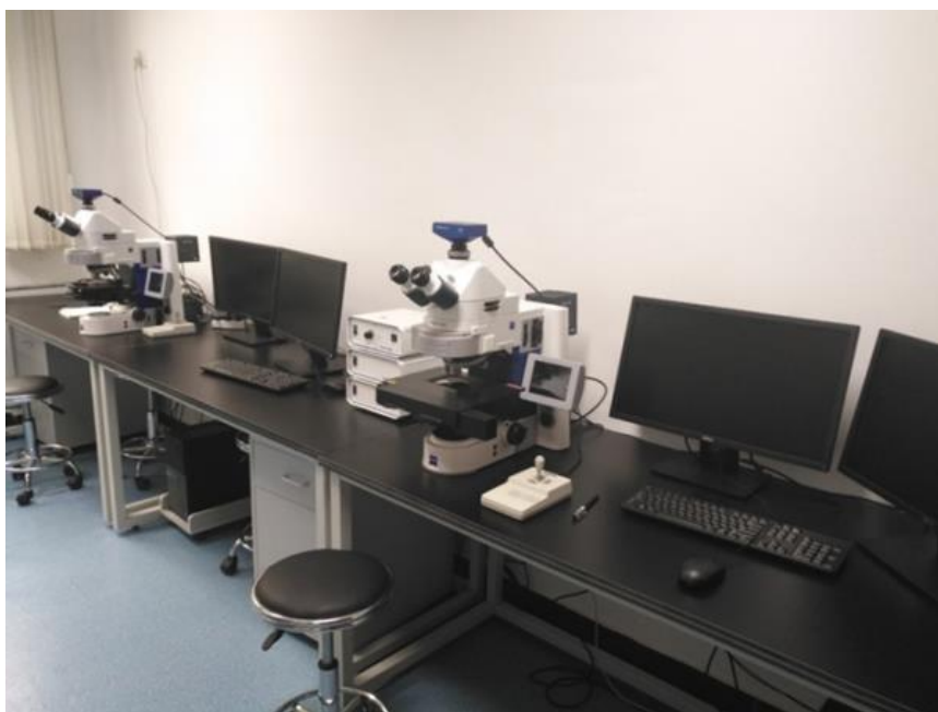
基于蔡司 Zeiss 显微镜的裂变径迹测量系统
