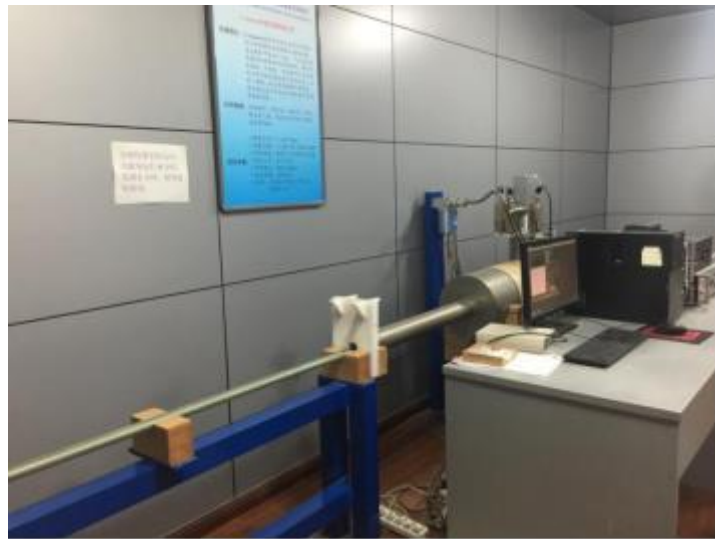
U-Channel 长岩芯岩石超导磁力仪系统
