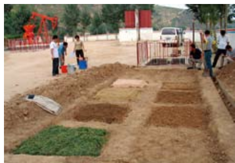
石油污染土壤原位修复试验
