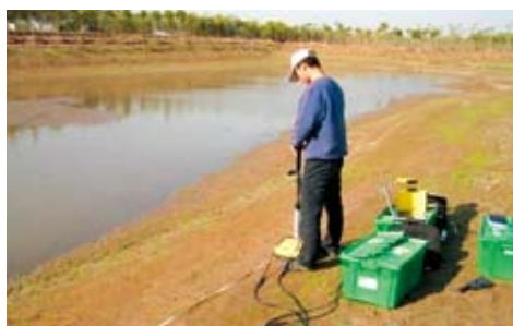
探地雷达测量土壤含水层
