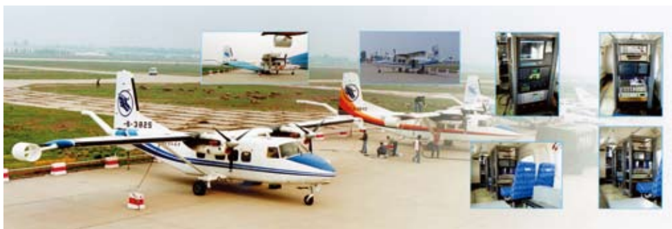
由 3 架 Y12II 型飞机组成的机队，搭载着物化探所航空物探室研制的 HDY-402 型三频航空物探（电磁放）综合站，在石家庄中核集团标准源上进行航空伽玛能谱仪静态及动态标定。
