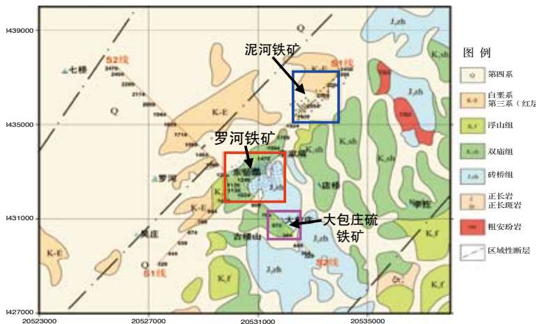
罗河、泥河、大包庄矿床地质简图及反射地震剖面位置 (S1、S2)
