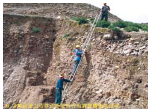
当雄盆地主边界断裂的古地震探槽揭露的多期古地震崩积楔和探槽编录过程
