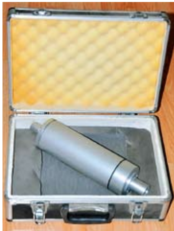
改造后的空心包体三轴地应力测量系统外形
